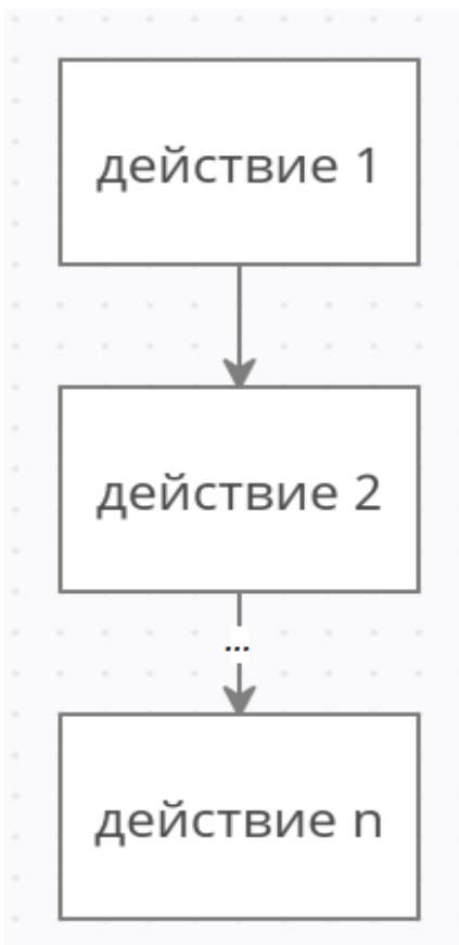
Рис. 107. Блок-схема линейного алгоритма
